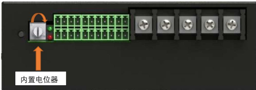
该内置电位器自带开关，当顺时针旋转至开关打开，继续顺时针旋转，电机按设定参数速度增加，反之则速度减少。
