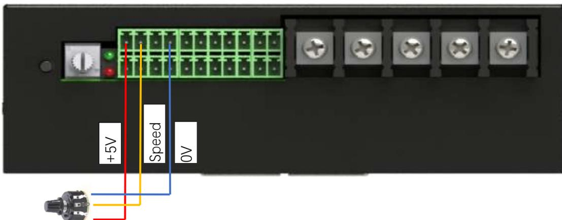
在自带电位器关闭情况下，外接电位器用于速度控制，电位器阻值推荐 10K。
