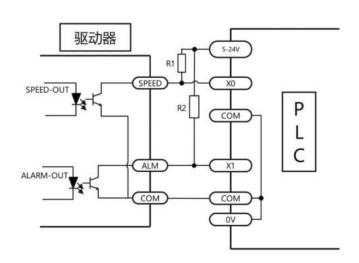
当电机出现过流、Hall 输入错误、堵转、过温、过压等情况的时候,驱动器便发出报警信号。此时故障报警输出端 (ALM)与公共端 (COM) 将断开,从而使故障报警输出端 (ALM)成为高电平,与此同时驱动器停止工作,报警灯闪烁。
