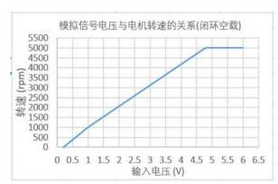
当输入电压大约为 0.3V 时, 电机速度为最高速度的 4%; 当输入电压大约为 4.7V 时, 机电的速度为最大值。 的速度
